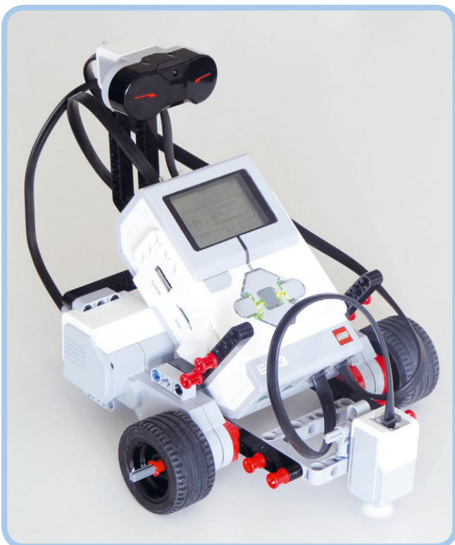
Рис. 7.1. Используя датчик цвета, EXPLOR3R может определять цвета и следовать по линии
