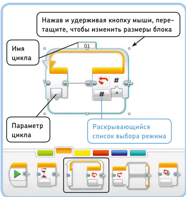
Рис. 5.4. Блок Цикл в режиме Подсчет . В данной конфигурации программа будет запускать любые блоки, размещенные в пределах этого цикла, четыре раза. В других режимах блоки, расположенные внутри цикла, могут повторяться в течение указанного количества секунд или неограниченного времени
