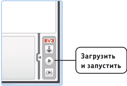
Рис. 3.4. Загрузка программы в память модуля EV3 робота и ее запуск. Если буквы EV3 на палитре подсвечены красным, значит, робот успешно подключен к компьютеру
