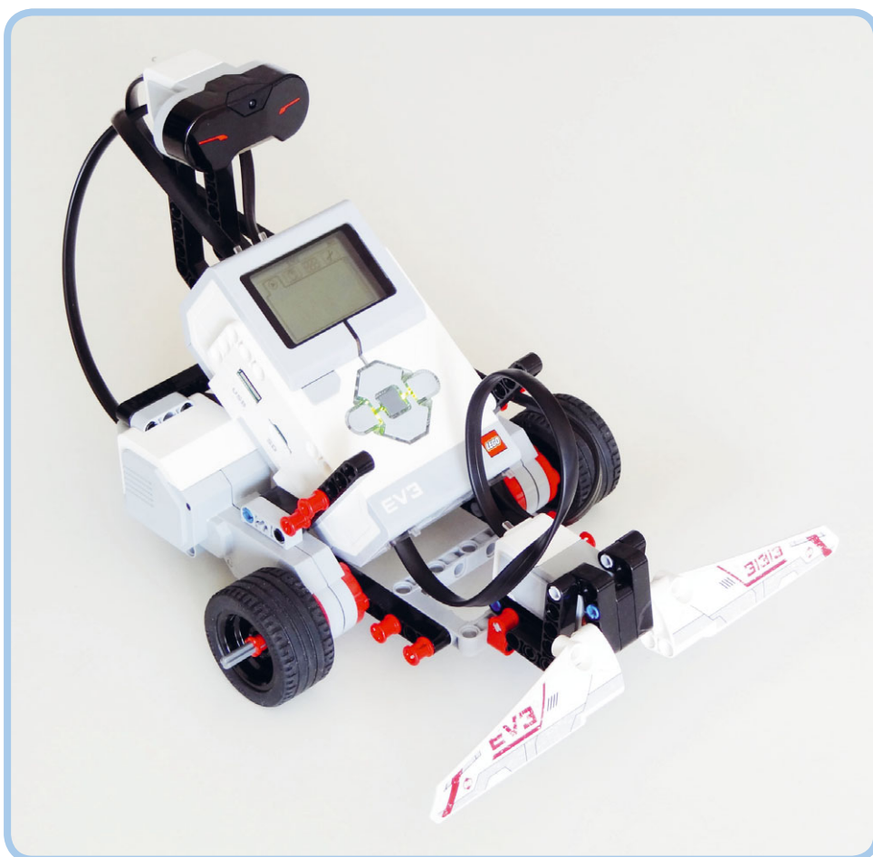
Рис. 6.1. Робот EXPLOR3R использует бампер с датчиком касания для определения объектов, в сторону которых он движется
