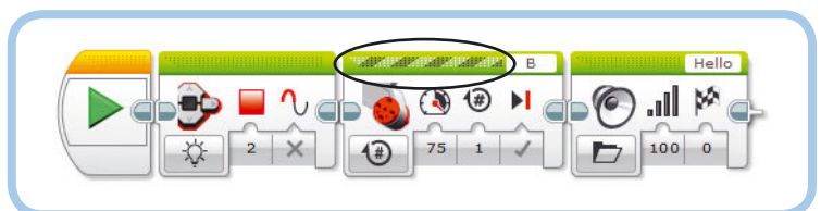
Рис. А.5. Перемещающиеся полоски указывают на то, что в данный момент работает блок Большой мотор . Вы увидите эти полоски, только если вы воспользовались кнопкой Загрузить и запустить ; они не видны, если вы запустили программу с помощью элементов управления в интерфейсе EV3
