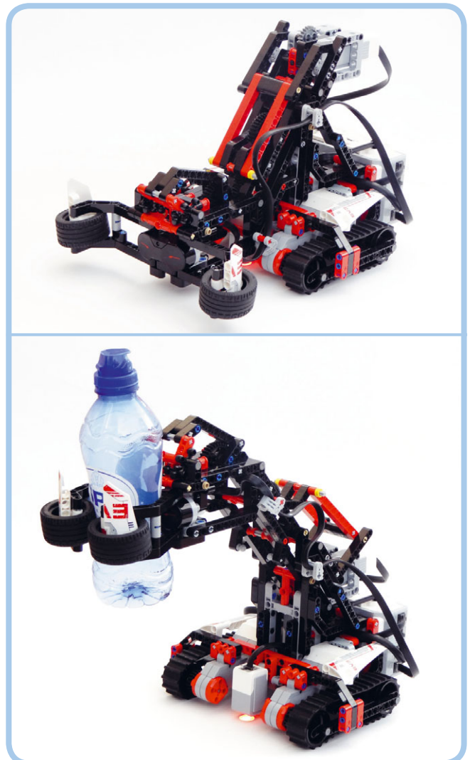
Рис. 18.1. Робот SNATCH3R может захватывать и поднимать легкие предметы, например пустую пластиковую бутылку
