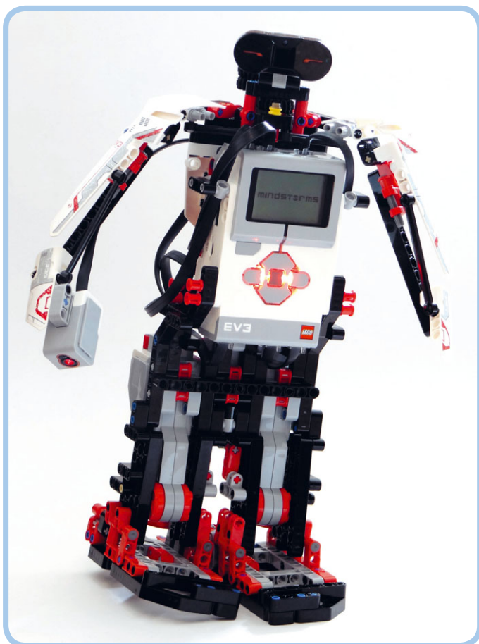
Рис. 19.1. Робот LAVA R3X ходит на двух ногах, двигая при этом головой и руками. Он приветствует вас, когда вы жмете ему руку
