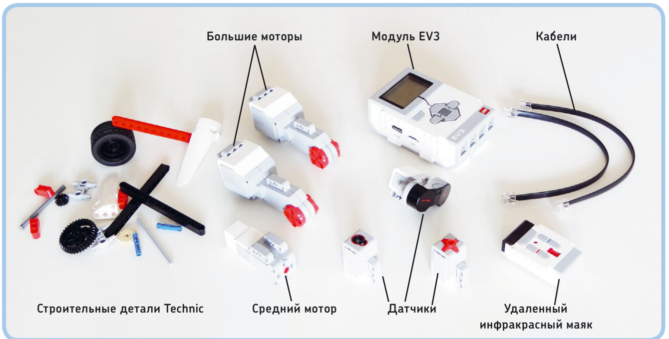
Рис. 1.2. Набор MINDSTORMS EV3 содержит строительные детали Technic, моторы, датчики, модуль EV3, маяк для дистанционного управления роботом и кабели
