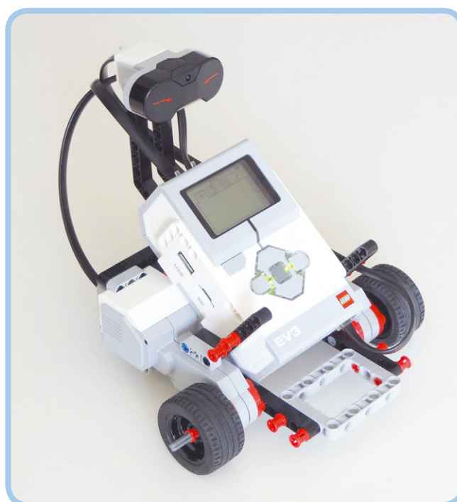
Рис. 2.1. EXPLOR3R перемещается на двух передних колесах и опорном заднем колесе
