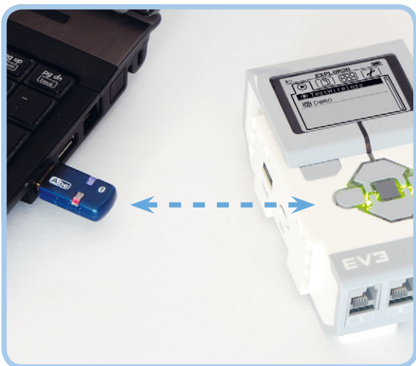
Рис. А.12. Один из вариантов беспроводного подключения через Bluetooth-интерфейс
