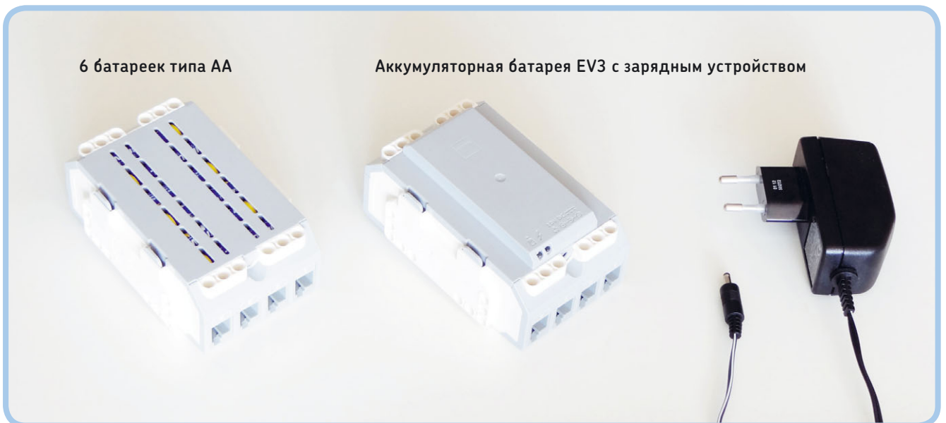
Рис. 1.3. Для обеспечения питания модуля EV3 можно использовать либо шесть батареек типа AA, либо аккумуляторную батарею EV3
