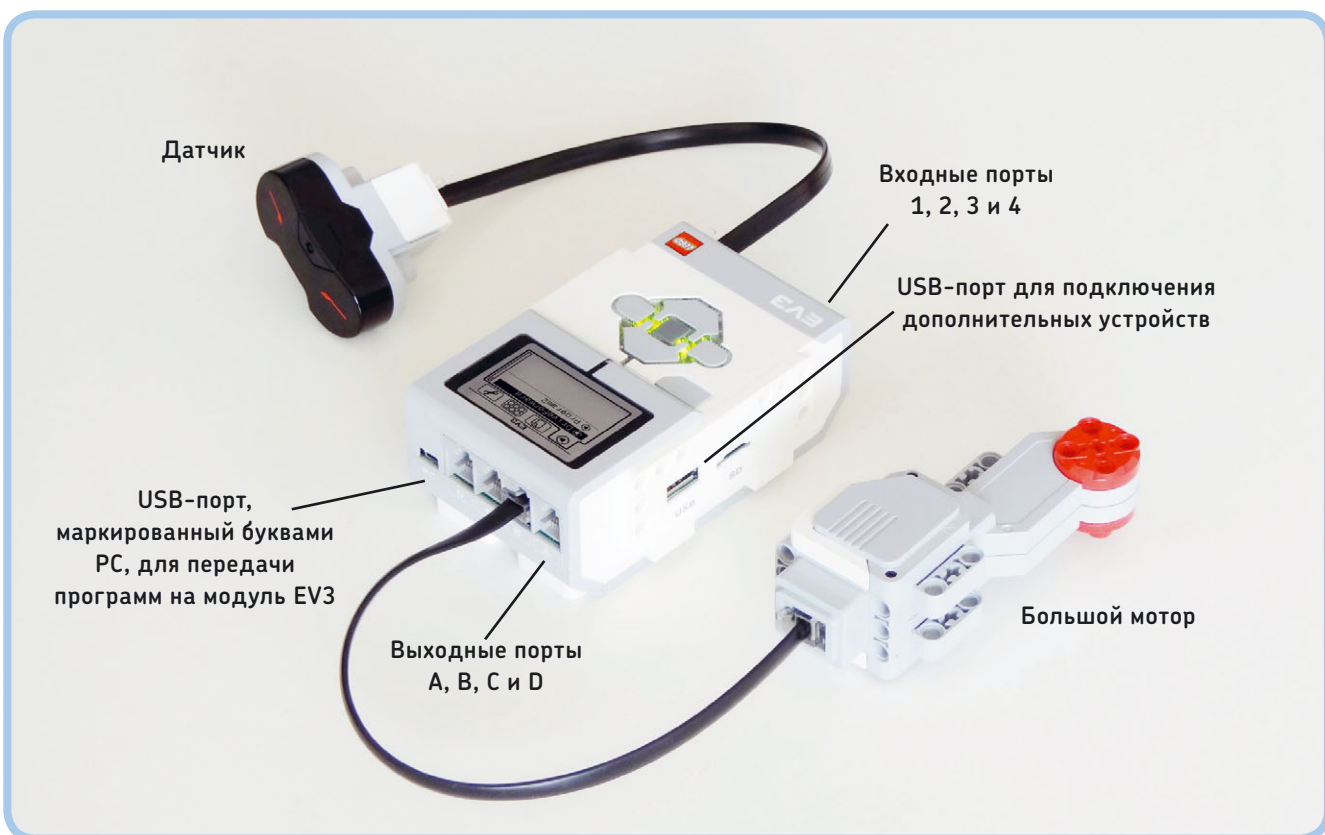
Рис. 2.5. Моторы подключаются к выходным портам, а датчики — к входным. Порт USB, который помечен буквами РС, используется для передачи инструкций с компьютера на модуль EV3
