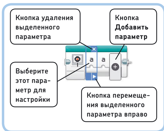
Рис. 15.17. Добавление, удаление и изменение порядка следования параметров
