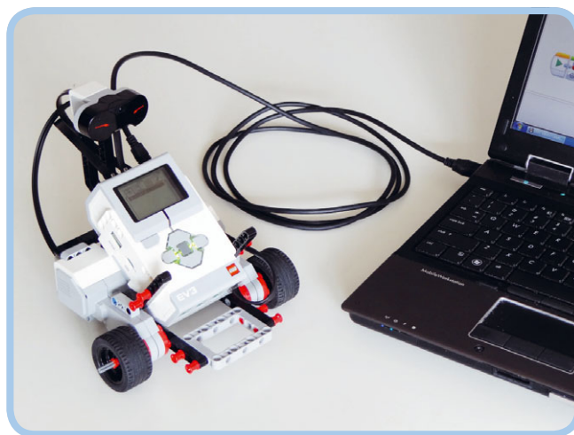
Рис. 3.1. Робот подключен к компьютеру с помощью USB-кабеля, входящего в комплект. Используйте USB-порт в верхней части модуля EV3, как показано на рисунке
