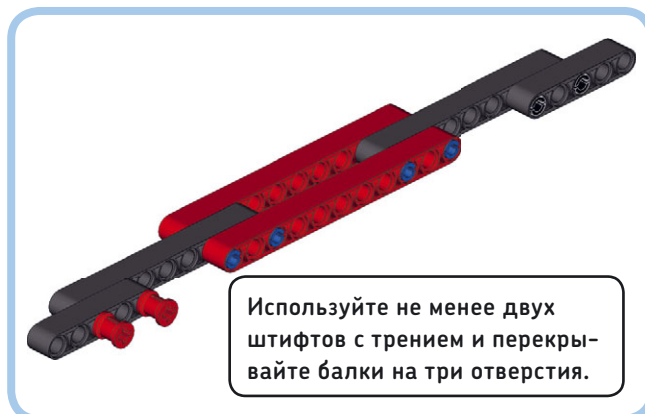
Рис. 10.3. Вы можете нарастить балки с помощью штифтов с трением (красные, синие и черные штифты в наборе)
