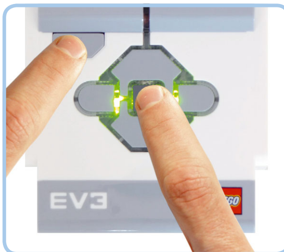
Рис. А.9. Чтобы перезапустить модуль EV3, нажмите одновременно центральную кнопку и кнопку «Назад» и удерживайте их до тех пор, пока не погаснет индикатор состояния модуля
