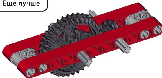
Рис. 11.23. Укрепление зубчатой передачи балками гарантирует, что зубцы не будут проскальзывать
