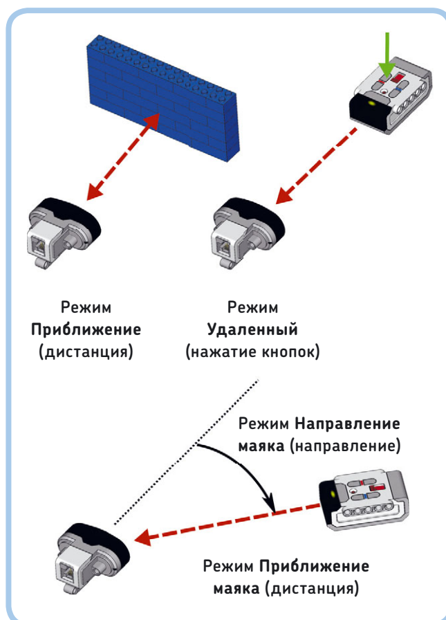
Рис. 8.1. Режимы работы инфракрасного датчика. Красные пунктирные линии обозначают невидимые лучи инфракрасного света. Если вы преградите путь между датчиком и маяком, датчик не сможет взять правильные замеры
