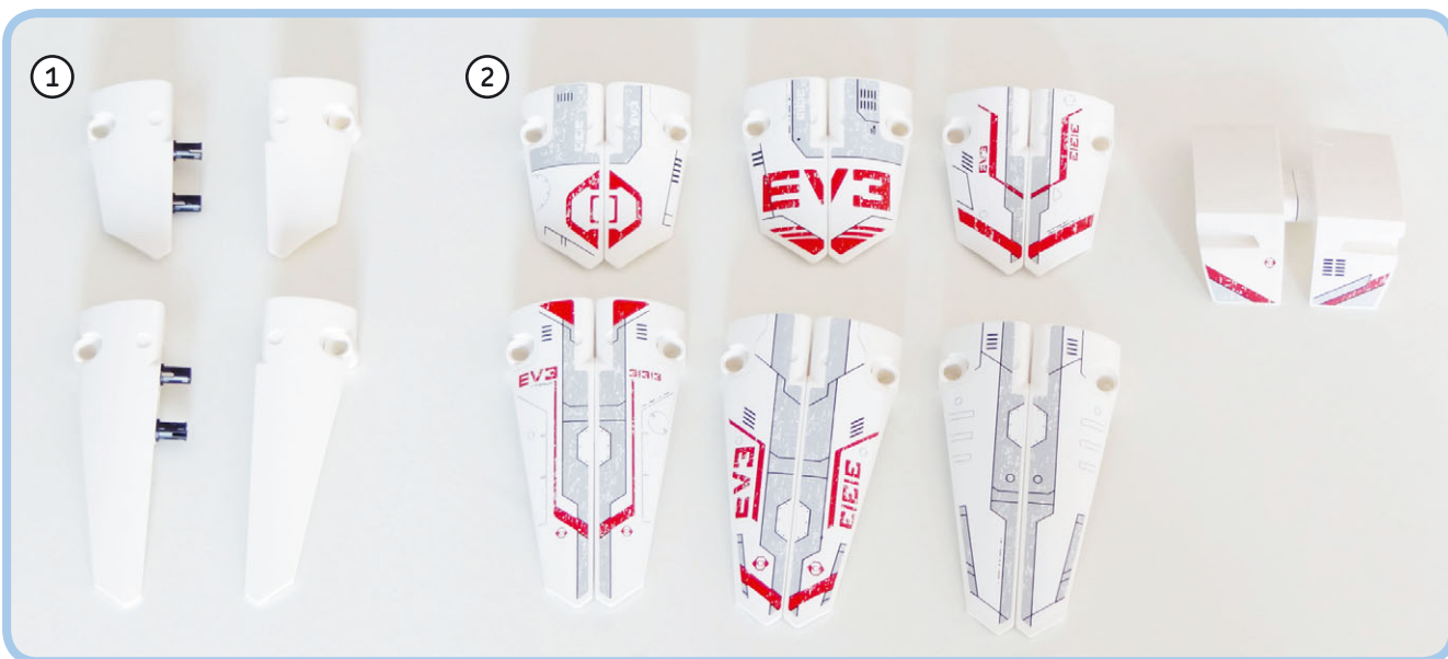
Рис. 1.5. Чтобы аккуратно прикрепить наклейки на панели, сначала соедините элементы панели с помощью двух черных штифтов. Так будет легче выровнять наклейку. Удалите штифты, когда закончите
