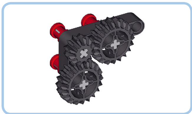
Рис. 11.13. Если сумма радиусов представляет собой дробное число, вы должны будете использовать фиксаторы для смещения на 0,5М, как описано в главе 10
