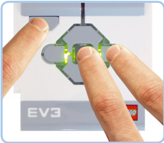
Рис. А.10. Чтобы вручную перевести модуль EV3 в режим обновления, удерживайте нажатыми кнопки «Назад», «Вправо» и центральную, пока не погаснет индикатор состояния модуля. После этого отпустите только кнопку «Назад». Когда на экране появится надпись Updating... , отпустите остальные кнопки
