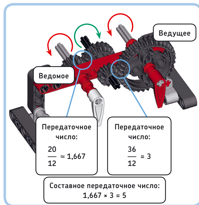
Рис. 11.8. Соединение двух пар зубчатых колес для достижения большего передаточного числа. Если вы не округлили промежуточные значения передаточного числа, составное передаточное число в этом примере будет ровно 5
