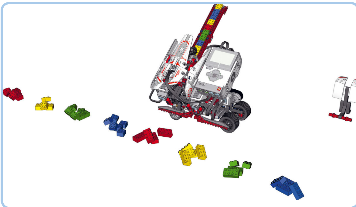
Рис. 19.21. Хотите собрать еще одного робота? Робот BRICK 50 RT3R сортирует детали LEGO по цвету (красный, желтый, зеленый и синий) и размеру (2×2 и 2×4). Инструкции по его сборке и программированию приведены в приложении Г
