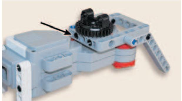
11. Вложи красную прямоугольную балку в крепление возле разъёма так, чтобы короткая сторона красной балки находилась справа. Зафиксируй её в креплении снизу с помощью двух бежевых штифтов, установив их во второй и четвёртый модули красной прямоугольной балки.
