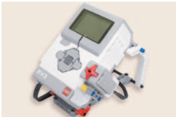
1. Соедини кнопку с портом № 1 программируемого модуля с помощью кабеля.
