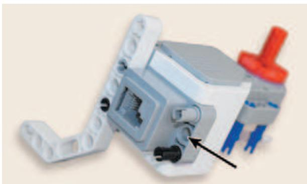
22. Теперь вставь один серый и один чёрный 2-модульные штифты в свободное крепление возле разъема большого мотора в первый и третий модули.
