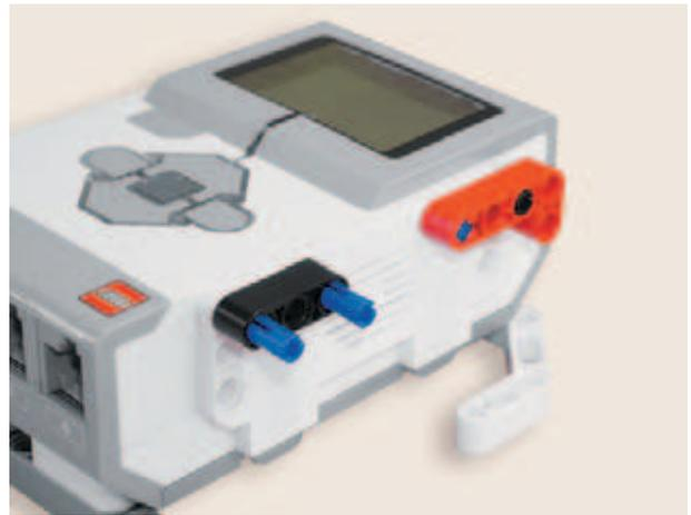
5. Вставь в угловой модуль красной балки синий 2-модульный штифт.
