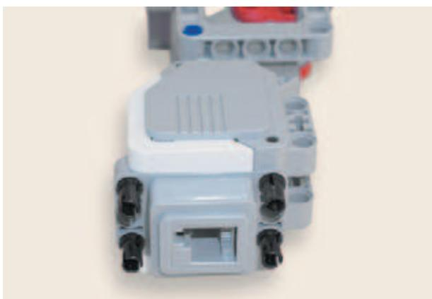
7. Поверни конструкцию так, чтобы разъём большого мотора располагался к тебе. Вставь четыре чёрных штифта по два в крайние модули возле разъёма большого мотора.
