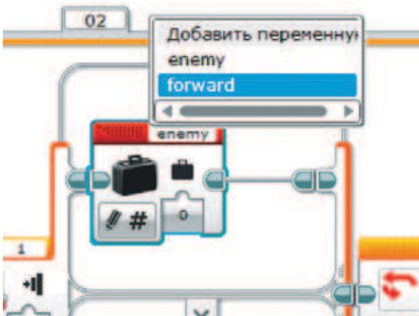
15. Сначала наполни ветку с выполненным условием. Вытащи **Переменную** (красный блок) и выбери режим **Записать**, значение **0** и переменную **forward**. Таким образом, ты запишешь во флаг, что движение производится НЕ вперёд.
