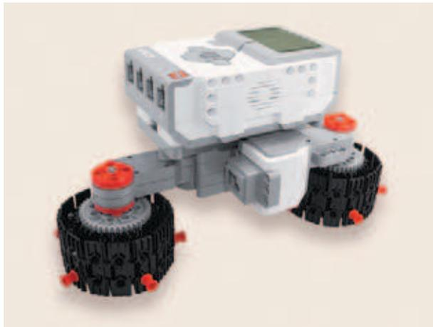
1. Возьми собранную конструкцию вместе с EV3 и поставь её на опоры, чтобы порты, обозначенные цифрами, были слева.
