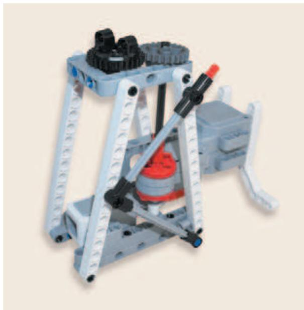
45. Переверни конструкцию башни так, чтобы разъём большого мотора находился слева, а датчик касания — справа. Вставь чёрный 2-модульный штифт в восьмой модуль белой балки № 15 слева, а серый 2-модульный штифт — во второй модуль белой балки № 15, расположенной справа.
