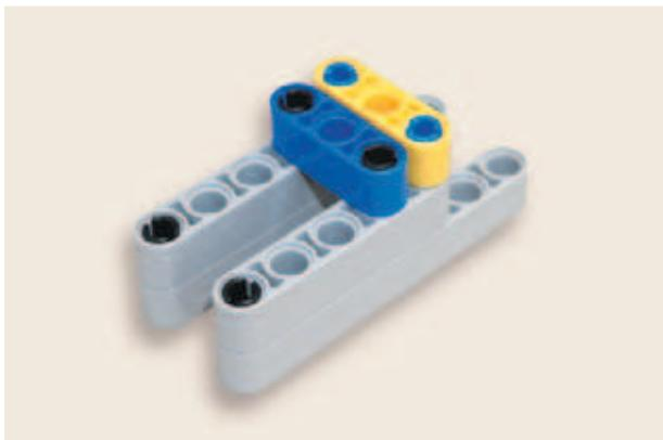
37. Надень на свободные концы синих штифтов жёлтую балку № 3 крайними модулями, а на концы чёрных штифтов — синюю балку № 3 крайними модулями, соединив таким образом серые заготовки.
