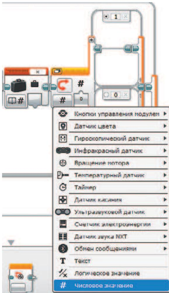
17. Теперь проверь, не достиг ли ты конца строки на экране. Для этого считай значение переменной  $x$  и проверь условие «Равно ли это значение 160?» (именно на 160-м пикселе и заканчивается строка экрана).
