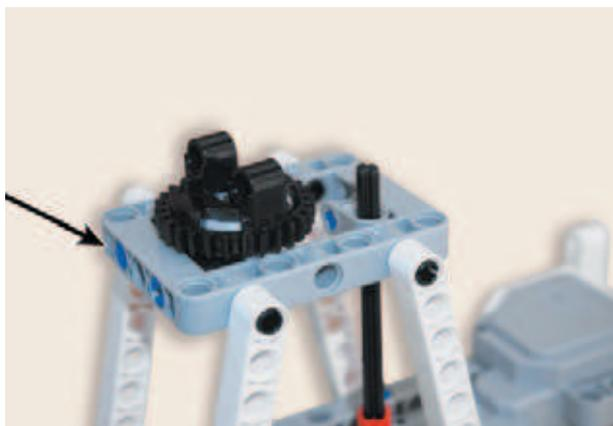
34. Вставь поворотный стол свободными концами синих штифтов в короткую сторону верхней рамки слева так, чтобы чёрная часть поворотного стола находилась сверху рамки.
