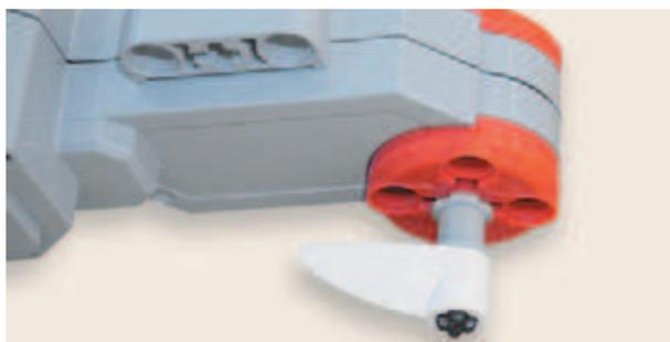
18. Надень на свободный конец чёрной оси с другой стороны от привода красную 2-модульную втулку (удлинитель оси).
