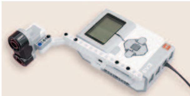
1. Прикрепи собранную на предыдущем шаге конструкцию к программируемому модулю: два чёрных штифта, установленные на программируемом модуле, должны войти в третий и пятый модули балки № 15 (считая слева направо).
