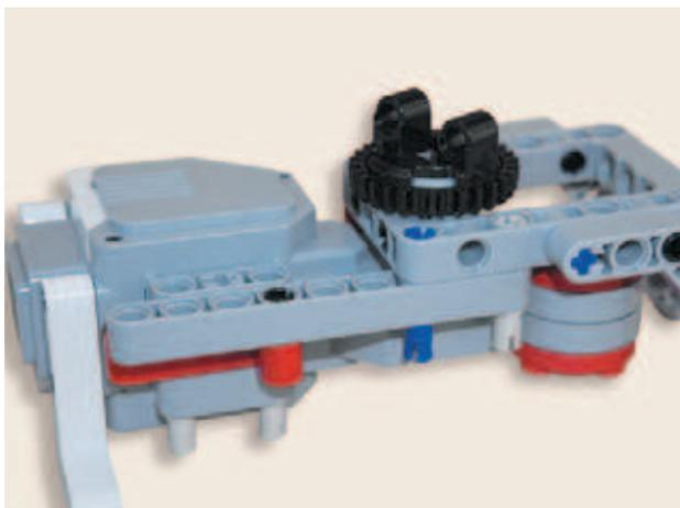
13. Надень серую балку № 9 четвёртым модулем на свободный конец чёрного штифта. Вставь синий и бежевый 3-модульные штифты длинными концами снизу в седьмой и девятый модули серой балки № 9. Они пройдут насквозь первый и третий модули рамки.
