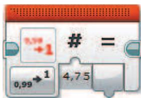
19. Теперь надо подумать. Результат вычислений может оказаться не целым, а такого быть не может! (Вспомни мультфильм, где были полтора землекопа!) Значит, прежде чем работать с этим числом, тебе надо его округлить. Округлять надо в бóльшую сторону, так как датчик может иметь погрешности в чувствительности измерений.
