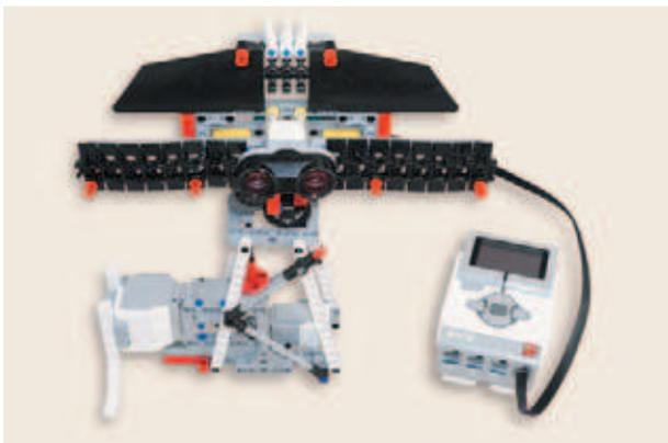
5. Вставь один конец длинного кабеля 50 см в разъём ультразвукового датчика, а второй конец — в порт № 4 модуля EV3.
