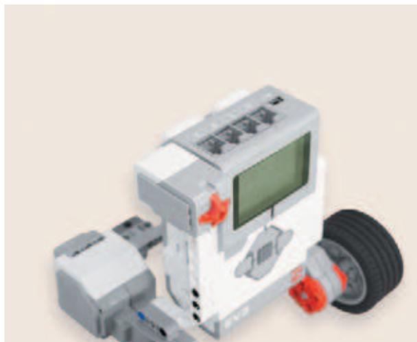
4. Аналогичным образом закрепи гироскопический датчик с правой стороны программируемого модуля.
