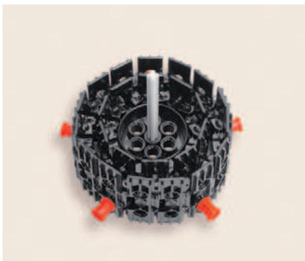
4. Переверни получившуюся деталь так, чтобы все штифты оказались ближе к поверхности стола. В центр зубчатого колеса вставь в его крестообразное отверстие ось № 7 так, чтобы она выступала только с одной стороны.
