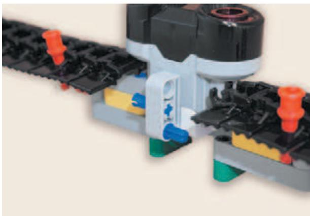
25. Для того чтобы прикрепить радар к башне, вставь 2-модульный синий штифт во второй модуль крепления ультразвукового датчика слева, а справа — в третий модуль крепления датчика.
