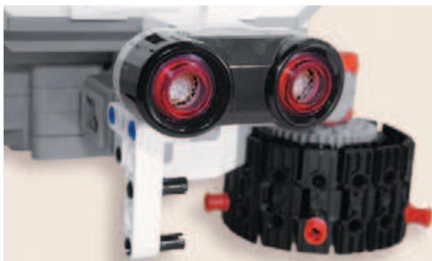
10. Вставь в третий и пятый модули балки 3×5 два чёрных соединительных штифта.
