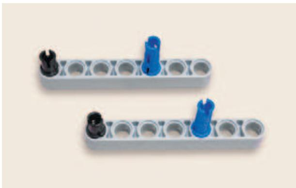
34. Вставь по одному чёрному штифту в первые модули двух серых балок № 7, а в пятые модули — по одному синему 3-модульному штифту короткими концами.
