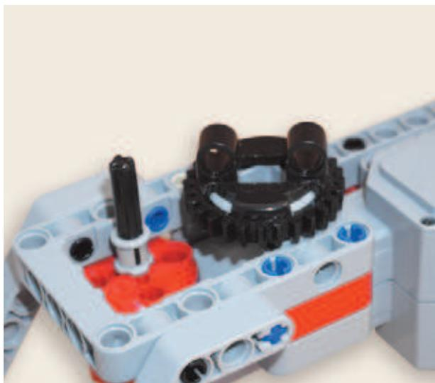
14. Вставь чёрную ось № 6 в ступицу большого мотора. Надень сверху на свободный конец оси серую втулку до упора.
