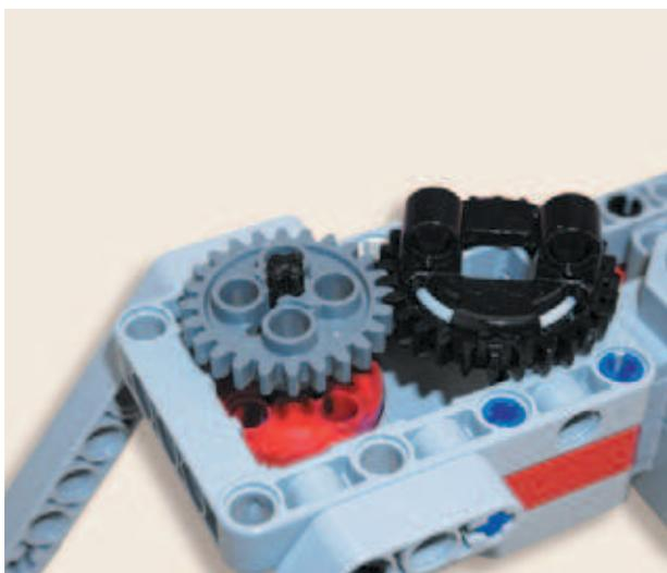
15. Надень сверху на ось серое зубчатое колесо на 24 зуба.
