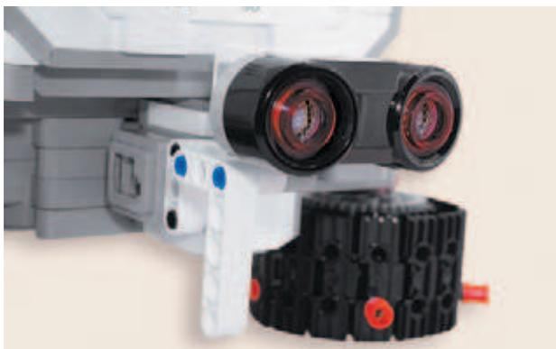
9. Установи слева от ультразвукового датчика белую прямоугольную балку 3×5 короткой стороной на свободные концы синих штифтов таким образом, чтобы длинный конец белой балки «смотрел» вниз.
