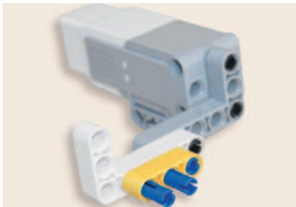
7. Установи два синих 2-модульных штифта в первый и третий модули короткой стороны белой прямоугольной балки.
