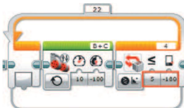
45. Осталась ещё одна команда в этой ветви. **Цикл 10** нужно прервать в аварийной ситуации, когда робот попадёт на край стола (или любой другой поверхности). При этом робот должен некоторое время не предпринимать никаких действий, кроме отката назад. Для этого после **Цикла 10** добавь команду **Ожидание** (оранжевый блок) и задай в качестве параметра задержки **5** секунд.
