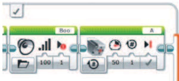
28. Произведи непосредственно выстрел пулемётом. Используй **Средний мотор** (зелёный блок) в режиме **Включить на количество оборотов**. Выстави мощность **50**, один поворот. Проверь, что наверху справа подписан порт **А**.
