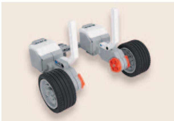
12. Установи колеса на подвижной платформе. Для этого вставь оси в центральные части приводов моторов длинными концами вперёд, пока колёса не упрутся втулками.
