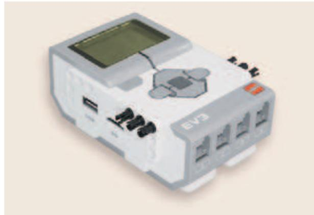
2. Установи программируемый модуль на колёсную базу. Для этого закрепи его между двумя двойными угловыми балками, вставив выступающие чёрные штифты в их пятый, шестой и седьмой модули сверху.
