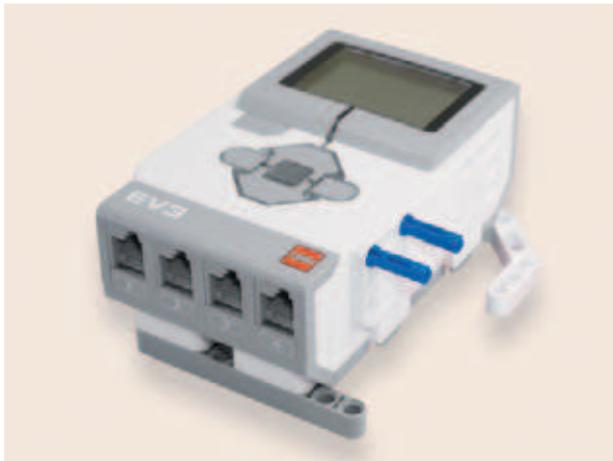
1. Переверни программируемый модуль экраном вверх. Вставь на его правой боковой стенке в первый и третий модули в верхнем ряду синие 3-модульные штифты.
