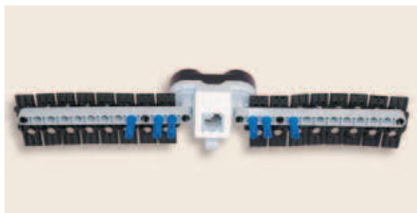
6. Надень на свободные концы синих штифтов левого «крыла» вторым и третьим модулями жёлтую балку № 3 до упора, а на конец штифта в девятом модуле — угловой соединительный 3×3-модульный штифт так, чтобы угловая часть находилась вверху и была направлена вправо.
