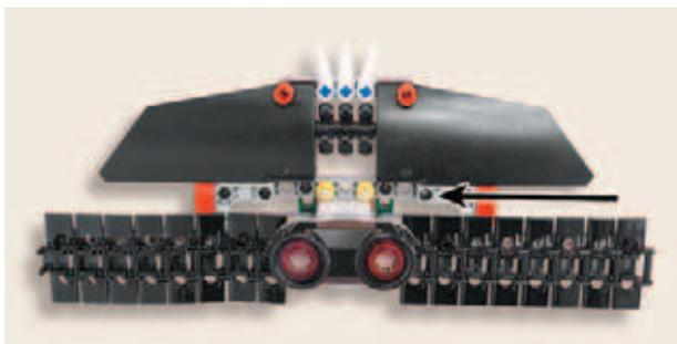
23. Положи собранную конструкцию радара так, чтобы разъём датчика находился сзади. Надень собранные вместе криволинейные панели на крепления серых угловых штифтов.
