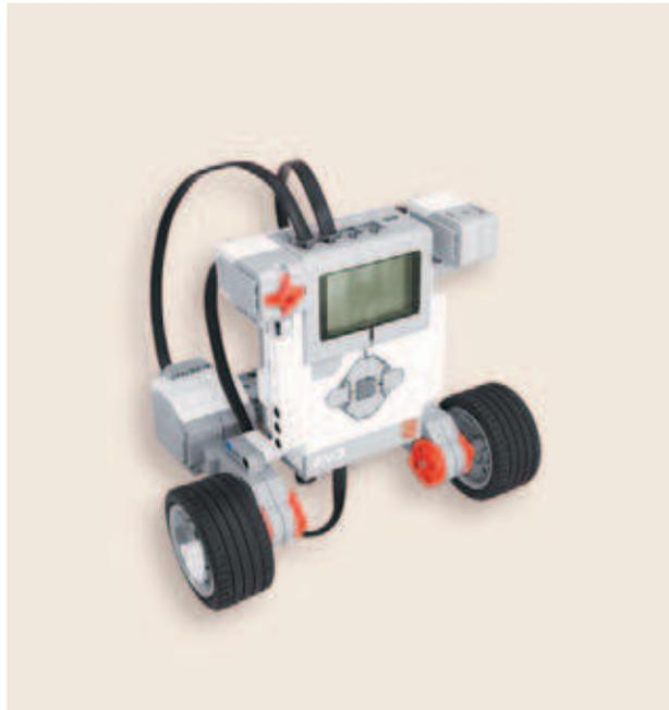
**Рис. 16.** Модель робота-спирографа
