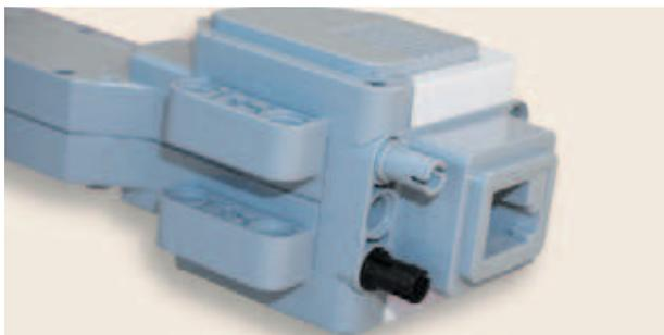
20. Теперь поверни большой мотор разъемом к себе и вставь в ближнем к тебе крепление возле разъема в верхний модуль серый, а в нижний чёрный 2-модульные штифты, как показано на рисунке.
