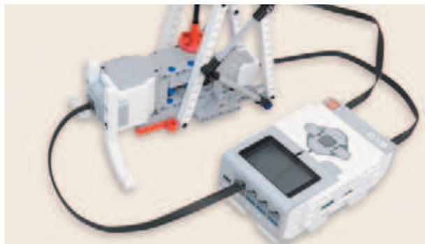
8. Соедини кабелем 35 см разъем большого мотора на основании пушки и порт С модуля.
