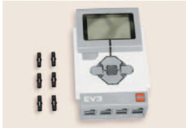
1. Вставь с двух сторон программируемого модуля по три чёрных штифта в верхние модули.
