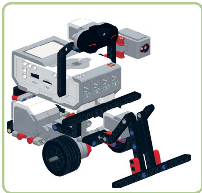
Рис. 8.3. Инфракрасный датчик, направленный вперед
