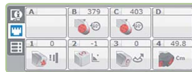
Рис. 4.31. Показания датчиков вращения моторов после выполнения первого блока Рулевое управление (Move Steering)
