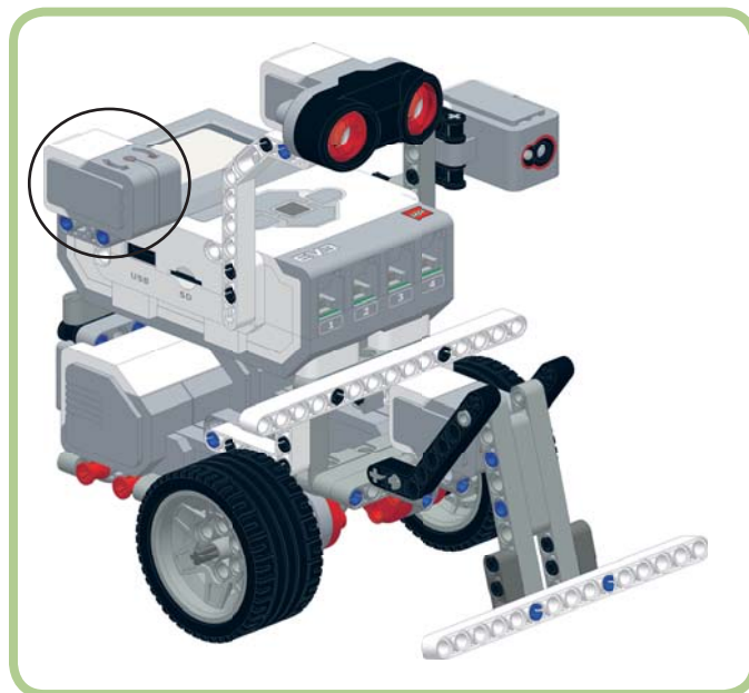
Рис. 5.42. Гироскопический датчик, установленный на работе TriBot
