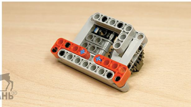
16. Возьми чёрную ось № 4 и зубчатое колесо на 8 зубьев и соедини их вместе.
