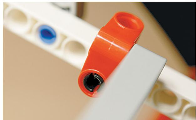
10. Теперь установи в крестообразное отверстие привода мотора справа синий 2-модульный штифт.
