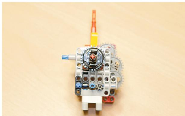
4. Придерживая обе стрелки в положении 12 часов ровно, закрепи угловую балку в сборе с зубчатым колесом, как показано на рисунке.
