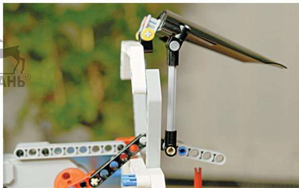
20. Чтобы механизм двигался плавно и не стопорился, возьми вилку поперечного блока и установи её в девятый модуль балки № 15 сверху циферблата — закрепи её осью № 3, продев её сквозь крестообразные отверстия.
