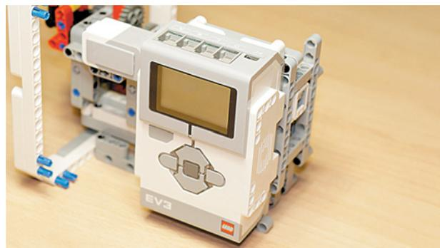
5. Для устойчивости модуля EV3 закрепи по бокам программируемого модуля по два штифта в верхний и нижний модули с каждой стороны.
