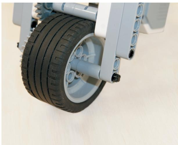
12. Надень на конец оси 2-модульную трубу и продень ось насквозь рамы.
