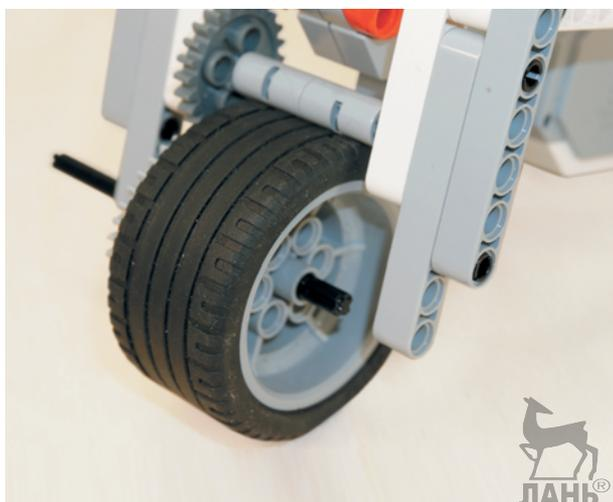
11. Собери колесо (надень низкопрофильную шину на ступицу) и надень его на свободный конец чёрной оси внутри рамы.
