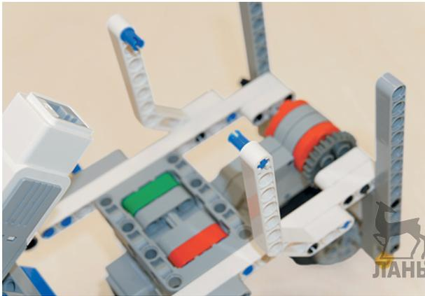
5. Далее возьми два синих 2-модульных штифта и вставь их в первые модули угловых балок 3×7 с внутренней стороны.
