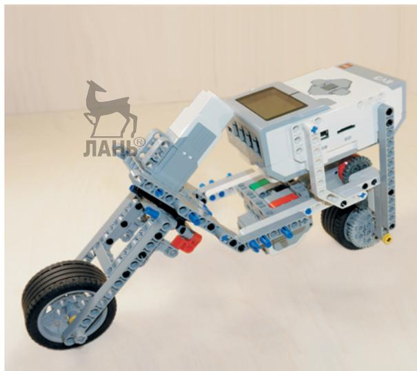
8. Вставь в третьи модули вертикальных креплений возле дисплея блока EV3 по одному чёрному штифту с обеих сторон.
