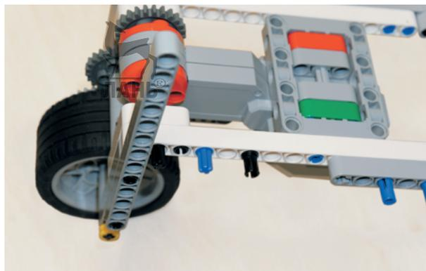
2. Далее возьми белую двойную угловую балку 3×7 и надень её на два штифта так, чтобы длинная часть этой балки находилась справа сверху.
