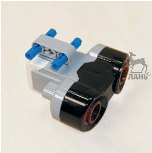
6. Теперь возьми ультразвуковой датчик и вставь в первый и третий модули его крепления два синих 3-модульных штифта длинными концами вперёд.
