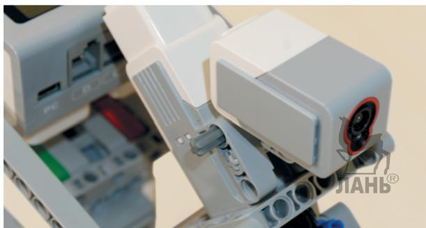
2. Далее возьми датчик цвета и вложи его между верхними модулями крепления мотора. Продень насквозь первый модуль снизу датчика с правой стороны серую ось с фиксирующим элементом.
