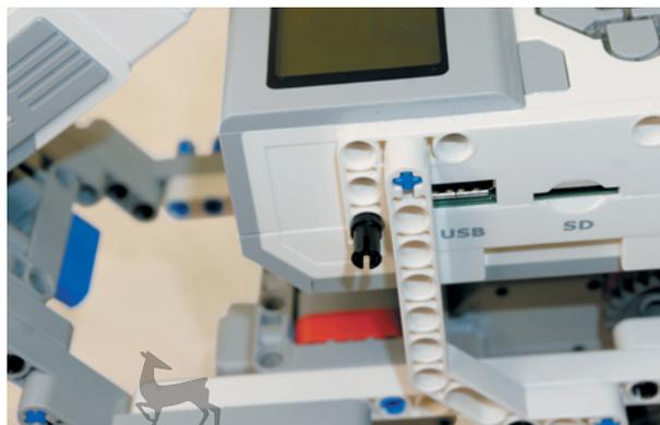
9. Теперь возьми две балки № 11 и надень их первыми модулями на свободные концы чёрных штифтов, а одиннадцатыми модулями — на синие 3-модульные штифты, расположенные на передней вилке в балках № 7.
