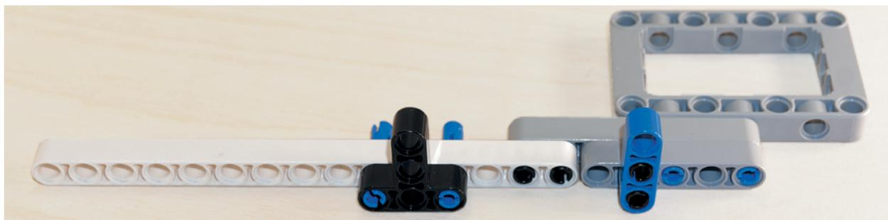
10. Надень с внутренней стороны белой балки № 15 на свободные концы синих штифтов белую прямоугольную балку 3×5 короткой стороной в первый и третий модули так, чтобы длинная сторона этой балки находилась снизу слева.
