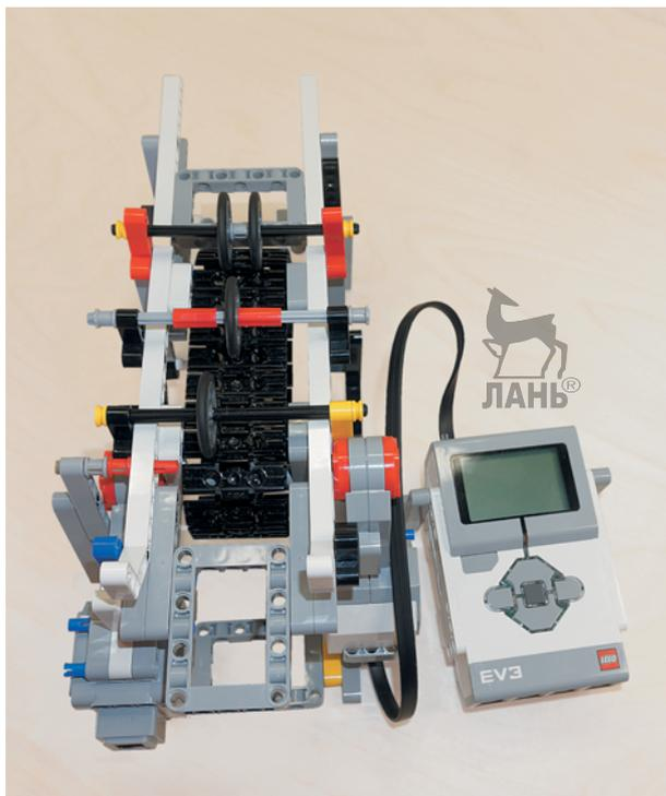
4. Соедини кабелем 35 см большой мотор, расположенный вертикально (ответчающий за наклон транспортёра), с портом **A**.
