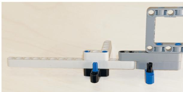
11. Вставь в чёрную тавровую балку 3×3 с внутренней стороны во второй модуль синий 2-модульный штифт с крестообразной осью.
