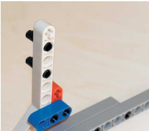
13. Далее возьми два чёрных соединительных штифта и вставь их в длинную часть двойной угловой балки 3 × 7 во второй и четвёртый модули с обратной стороны.
