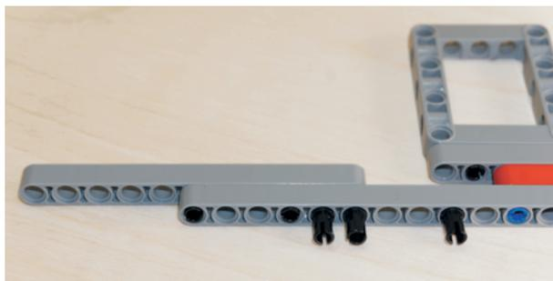
8. Установи снаружи на штифты балки № 13 красную прямоугольную балку 2 × 4 так, чтобы её длинная часть располагалась справа и «смотрела» вверх.
