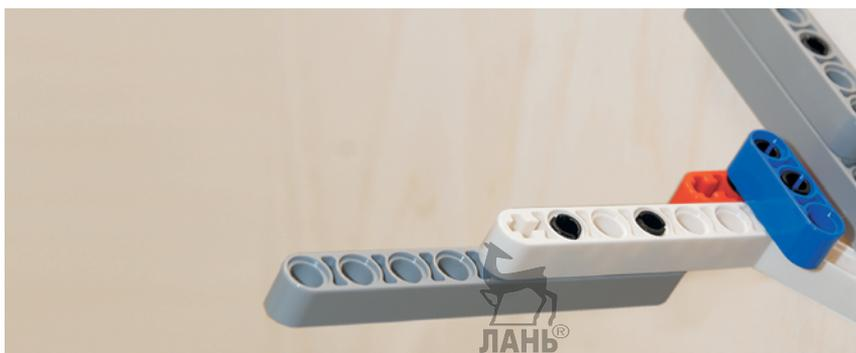
15. Вставь в первый и четвёртый модули балки № 9 два чёрных штифта и надень на них серую балку № 7 первым и четвёртым модулями.
