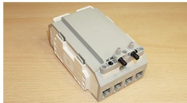
9. Переверни программируемый модуль экраном вверх. Установи его на шасси между двумя угловыми балками 3 × 7. При этом чёрные штифты должны войти в пятый и седьмой модули задней балки шасси. Штифты на угловых балках должны войти в боковые отверстия модуля EV3.
