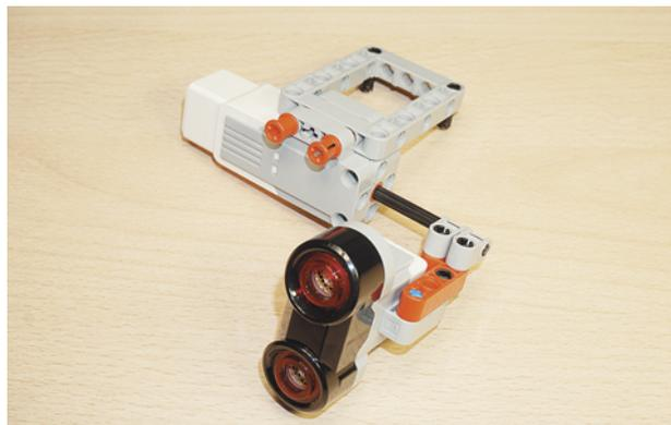
8. Установи получившуюся конструкцию с левой стороны программируемого модуля во второй и пятый модули угловой балки.
